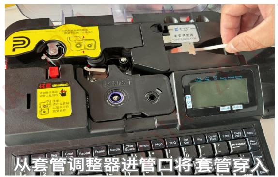
套管穿过打印头,并将一端套管拉出到切刀位置。
